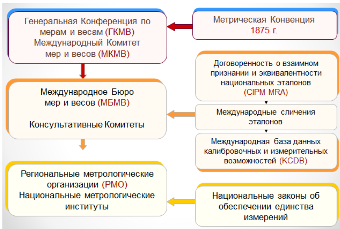
Рис. 3. Схема взаимодействия элементов международной системы обеспечения единства измерений
